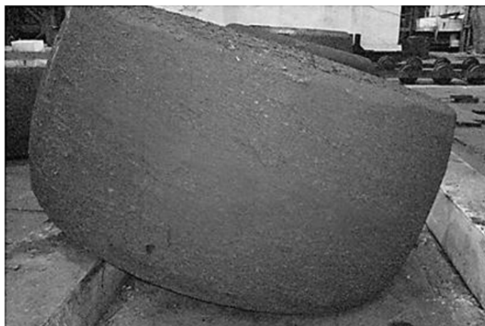
Рис. 4. Поковка-шайба стали 10X18Н9-ВД Ø1020 мм высотой 560 мм
