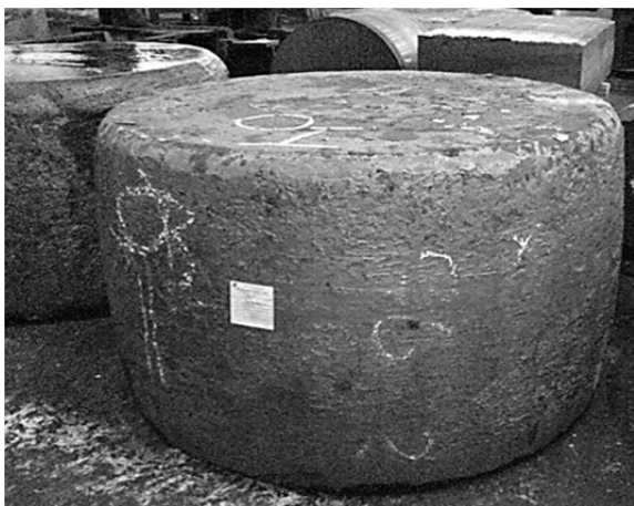
Рис. 3. Поковка-шайба стали 10X2М-ВД Ø1020 мм высотой 620 мм
